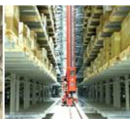
自動立体倉庫
