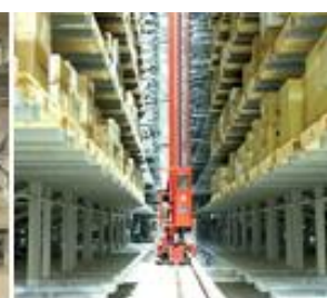
自動立体倉庫
